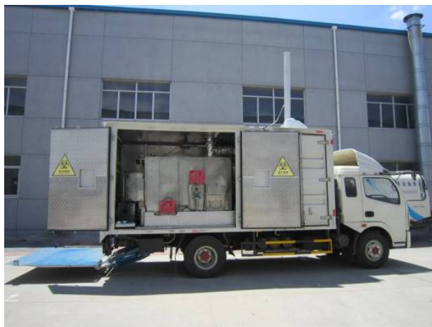
图3-6 医疗废物处理样车现场图
