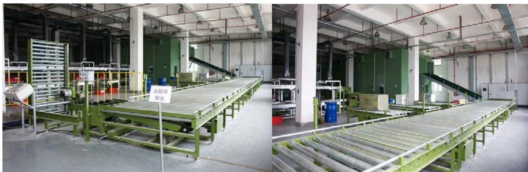
图 3-28 废冰箱、废洗衣机、废空调拆解线
