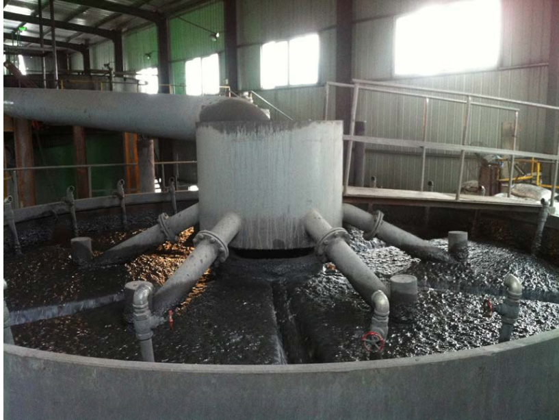
图 2 江西力合华拓能源开发有限公司——粉煤灰高效脱碳分选系统
