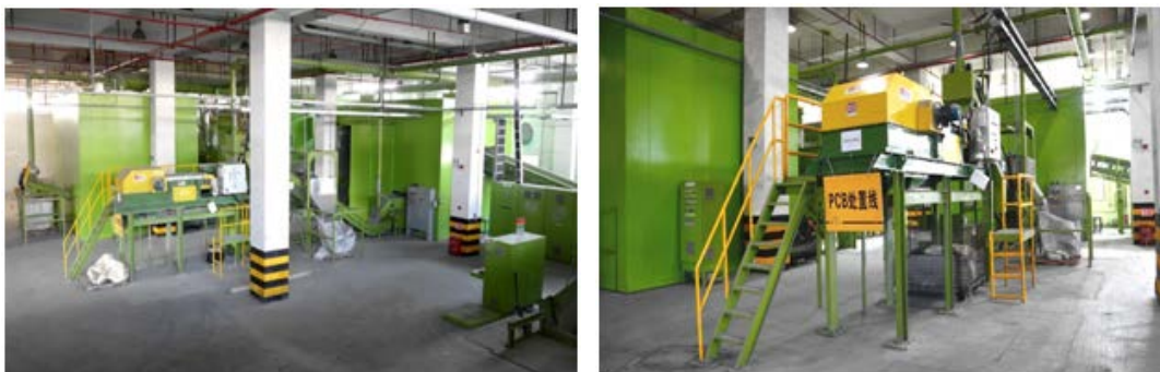
图 3-2 多级破碎-复合分选成套装备
