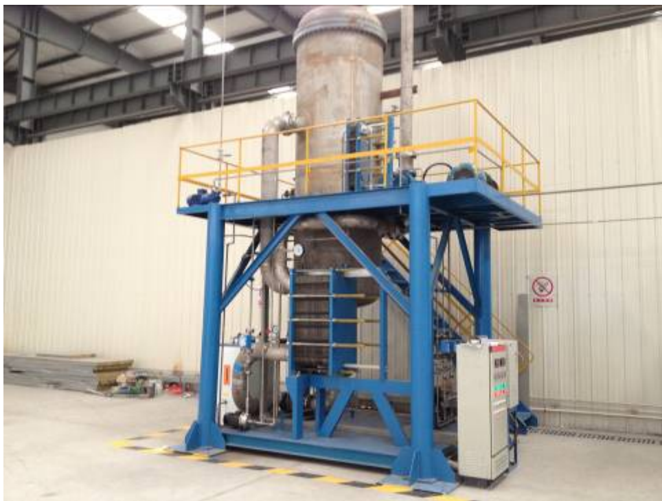
图4-5 机械式蒸汽再压缩（MVR）蒸发器
