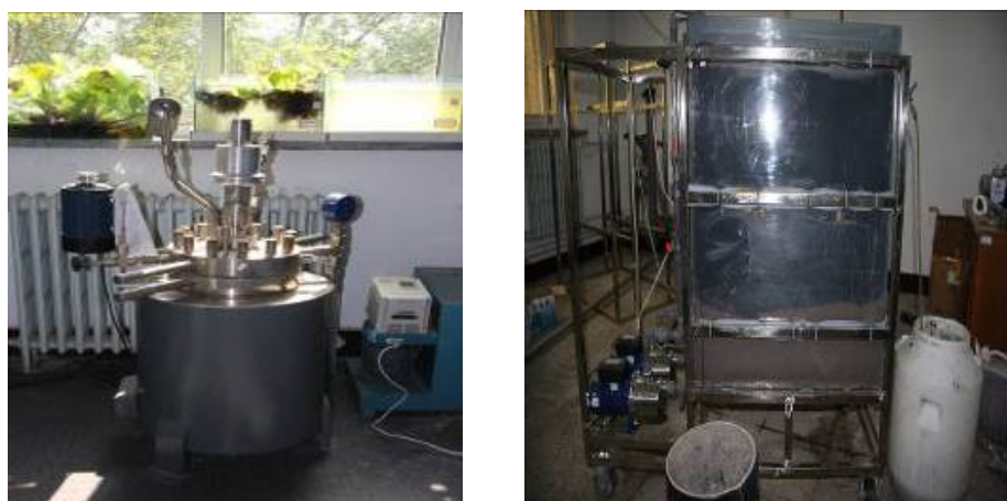
图3-10 含铅飞灰稳定化处置小试装备
