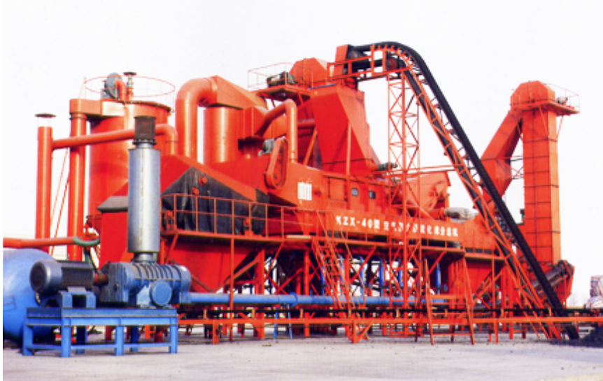
图 8 模块式干法重介质流化床选煤系统及设备
