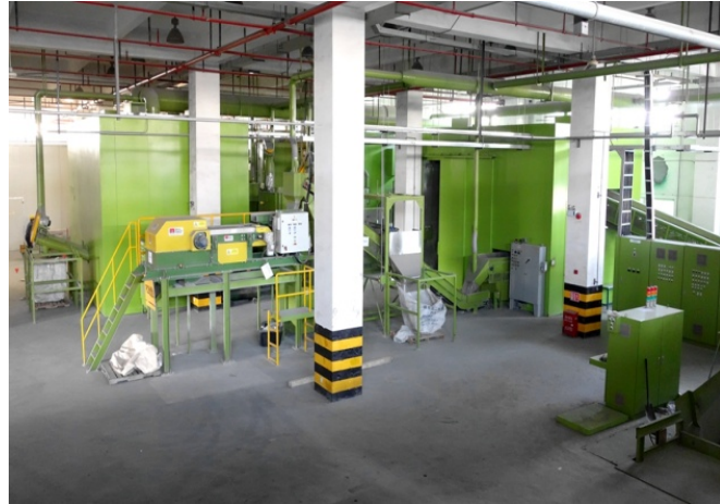
图 3-39 废线路板处置系统
