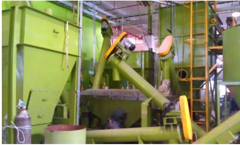
图 3-3 辊式-锤式破碎-风选-磁选-高压静电分选生产线
