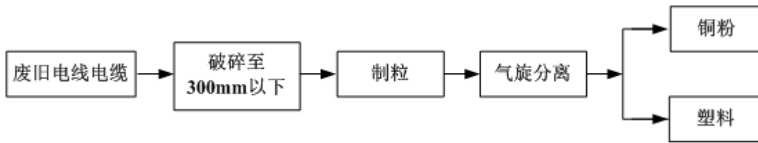
图 3-36 废电线电缆处理技术线路图
