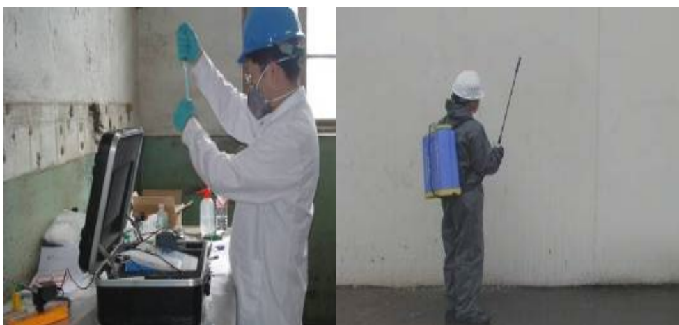
图4-3 农药污染场地的现场快速检测与墙面清理前的预处理工作
