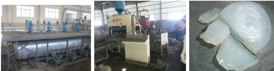
高砷固废热压熔融固砷车间 高砷固废源头脱砷设备 热压熔融固砷体外观
