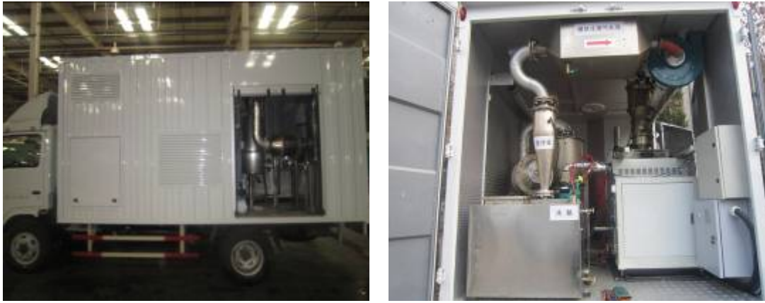
图3-15 医疗废物车载式无害化处理平台
