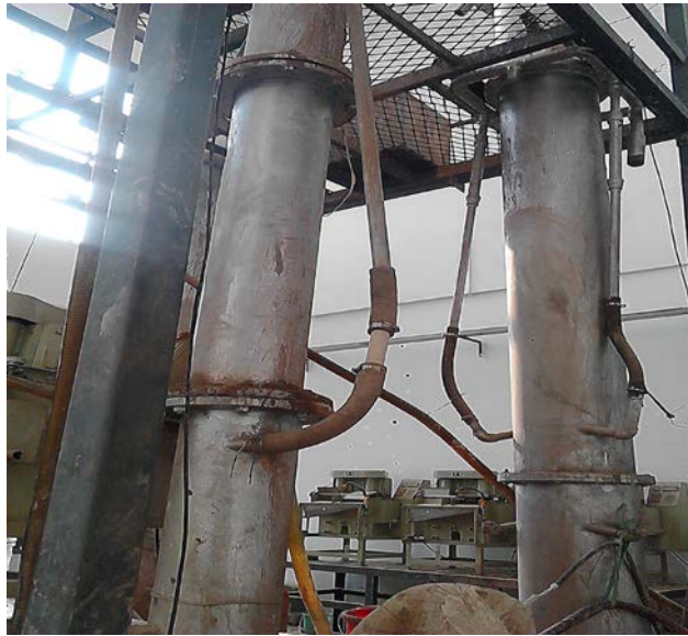
图 4 细粒分选及机/柱联合分选工艺系统
