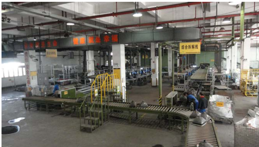
图 3-30 废台式电脑拆解线
