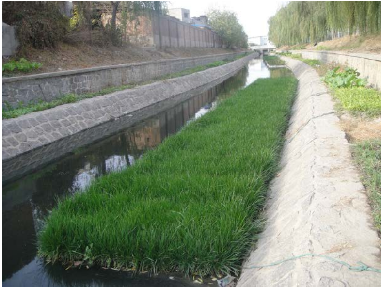
图 7 无土草坪人工浮床技术净化河道水体试验
