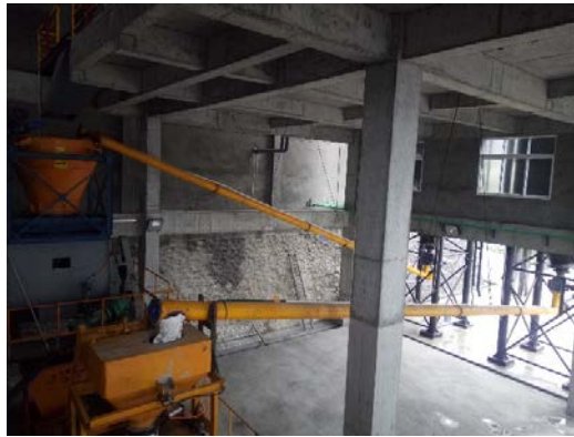
含砷废渣晶化及胶凝进料螺旋输送系统
