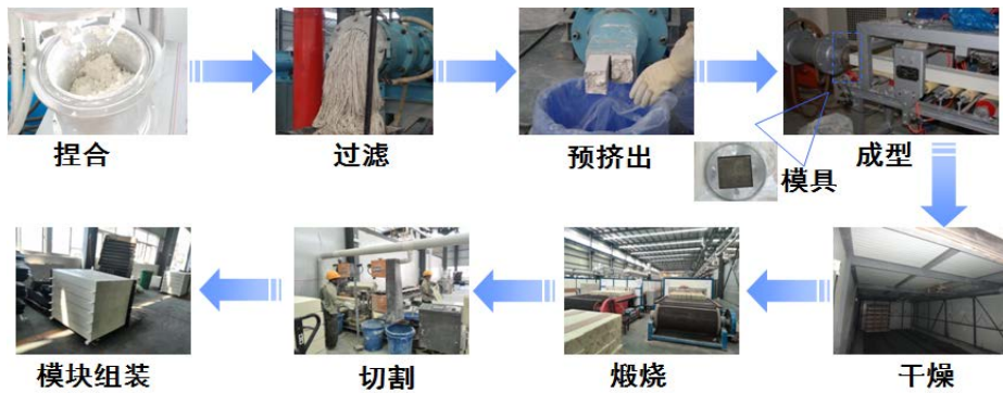
SCR 脱硝催化剂成套生产工艺技术及装备
