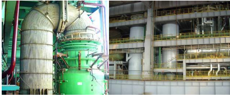
“塔-环隙”系统中的蒸发冷却塔隙洗涤装置的工程应用
